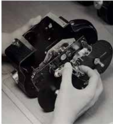
Montage de la platine et du mécanisme dans le bâti de la caméra H16, 1954. Archives cantonales vaudoises, fonds Paillard-Hermès-Precisa, PP680/3185.
